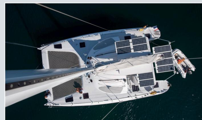
Longueur HT : 12,44 m. Largeur 7,05 m. TE : 1,04 m. Déplacement : 5 800 kg. Surface du mât : 6 m<sup>2</sup>. SV au près : 105 m<sup>2</sup>. SV au portant : 180 m<sup>2</sup>. Motorisation in board : 2 x 27 ch. Architecte : Erik Lerouge.
