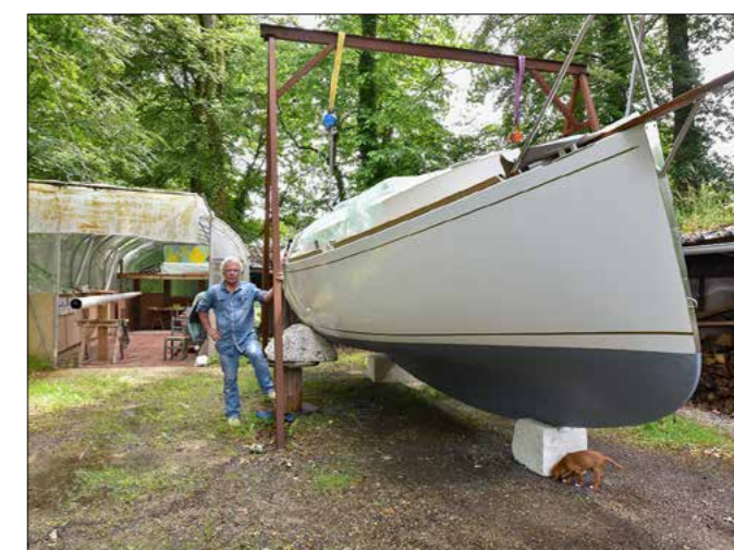
▲ Portique et palans permettent à Antoine de gérer les manutentions. Le troisième Pabouk 700 sort tout juste du chantier.
